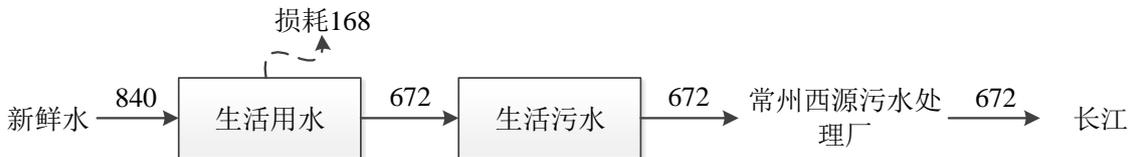
附图 5-4 本项目水平衡图 (单位: m<sup>3</sup>/a)
