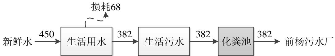
图 2-1 项目水平衡图（单位：m<sup>3</sup>/a）
