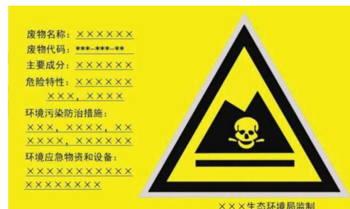
图5-6 贮存设施内部分区警示标志牌
