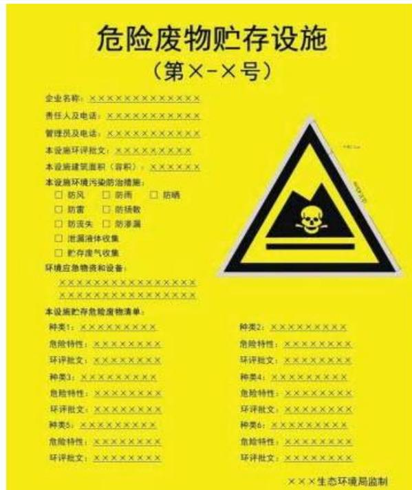
图 5-4 平面固定式贮存设施警示牌
